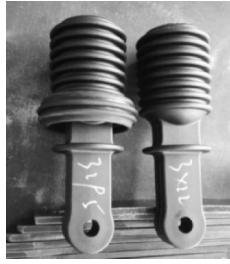
图2 绝缘拉杆伞裙热缩套安装位置
